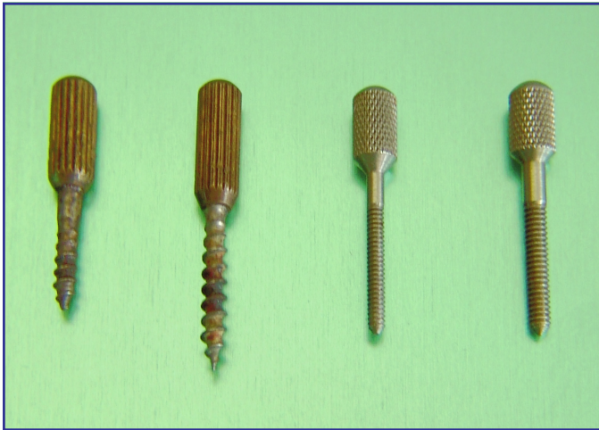
Abb. 30: 1. Prototyp - Wurzelanker verschiedener Länge und Durchmesser
