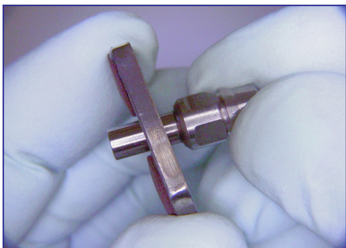
Abb. : Abziehschraube und Auflageplatte passen form-schlüssig zusammen
